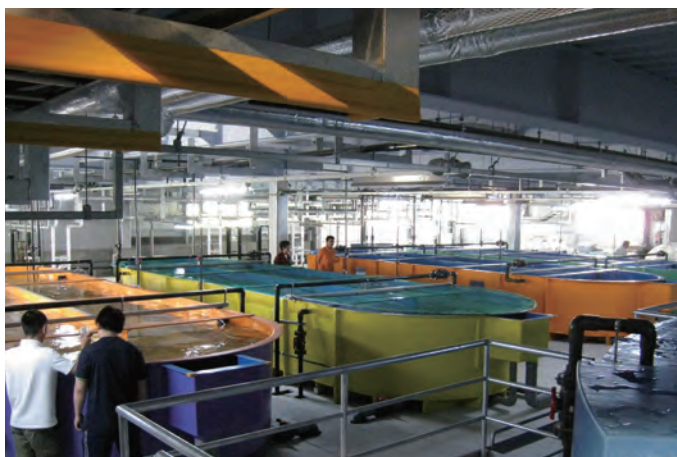
■研究施設水槽 10,000×3,000×1,200H(4基) レースウェイ水槽
