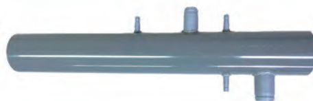
■排液マニホールド 接続口(タケノコ)マシニング加工+塩ビ溶接
